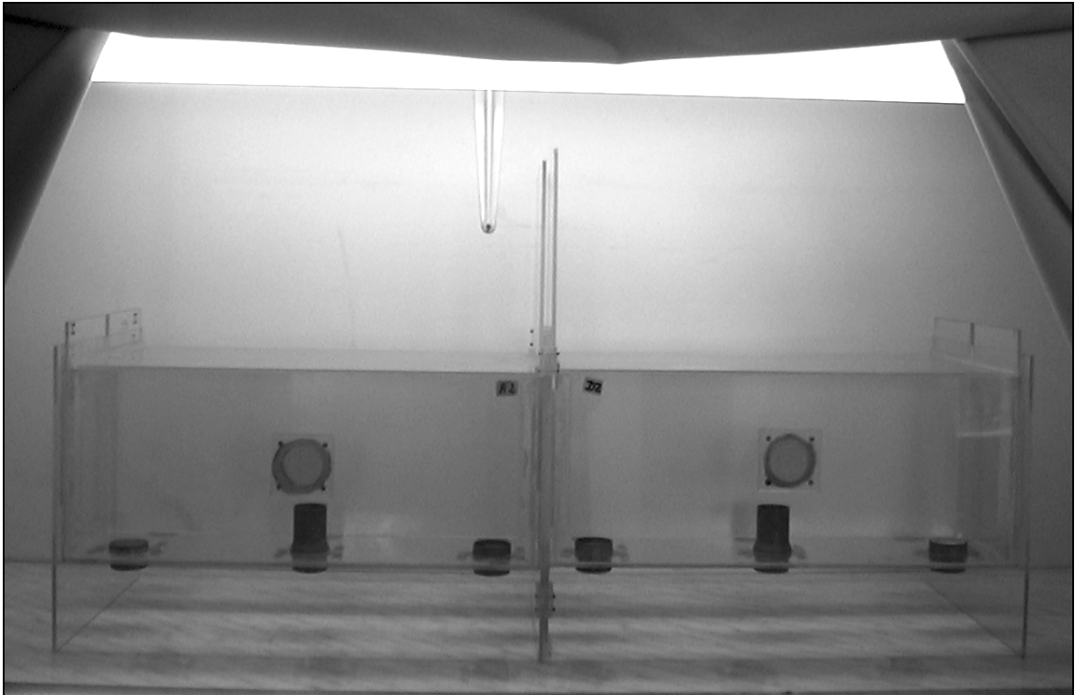
Figure I-4 : Photographie du dispositif obtenu en assemblant deux éléments. Le dispositif est placé sur une des étagères munies de rampes lumineuses qui ont été utilisées pour toutes les expériences.
